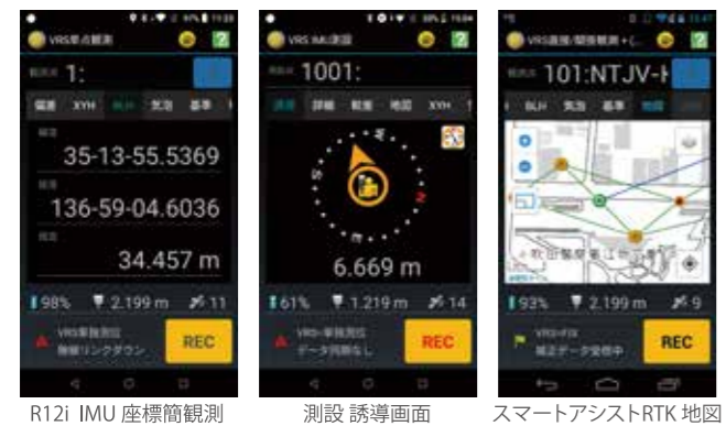
R12i IMU 座標簡観測 測設 誘導画面 スマートアシストRTK地図
