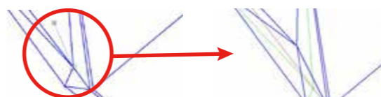
CADポイントを移動すると、それに接続する全ての線図形が移動
