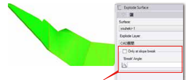
「Only at slope break」 三角形とそれに隣り合う三角形の法線ベクトルを比較し、その2つの法線ベクトルがなす角が指定した角度を超えている場合に、三角形同士の境界線をラインストリングで作図。このオプションが有効の場合、頂点にCADポイントは作図しない
