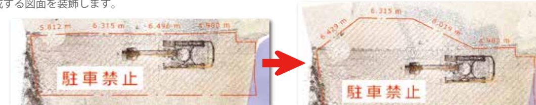
ハッチングとラベルを作図した領域の「領域線」の形状を変更するだけで、ハッチング領域の自動訂正とラベルの値(距離)が自動修正される
