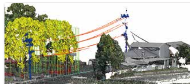
フィットラインで点群から自動作成した、多項式曲線3Dの「電線」(赤線)
